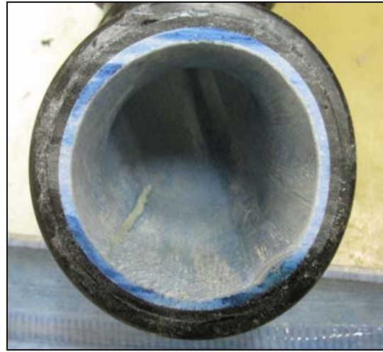
Fig. 64: Eksempel tverrsnitt – strøpemetoden
