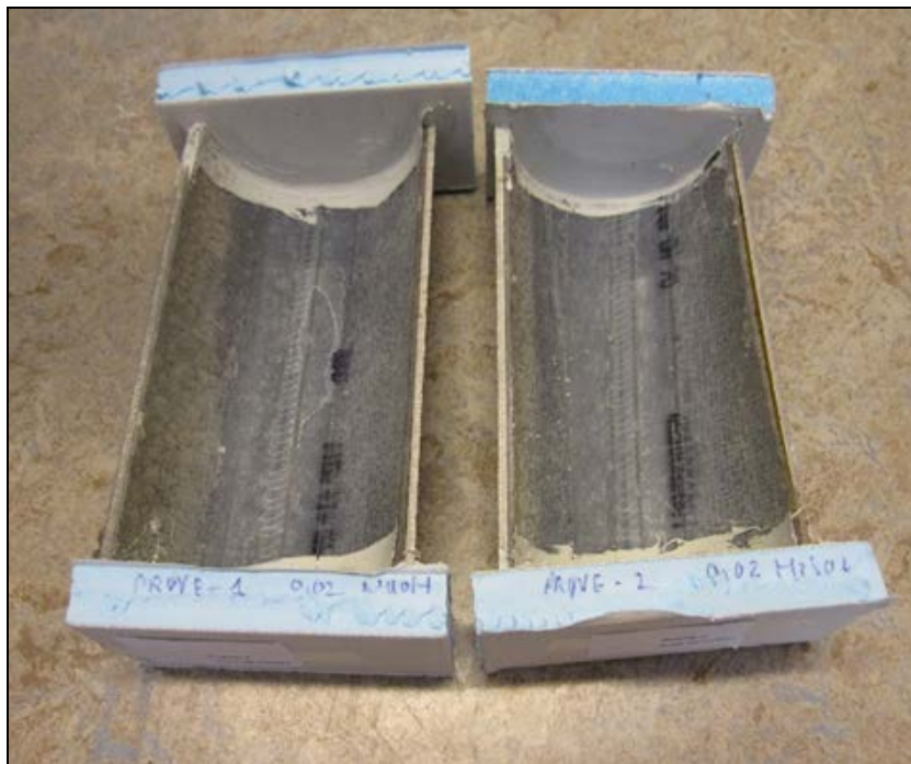
Fig. 34: Prøveobjekter for kjemisk belastning, splittet rør med relining
