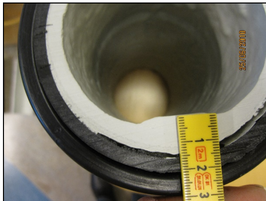
Fig. 65: Eksempelmåling av beleggetykkelse
