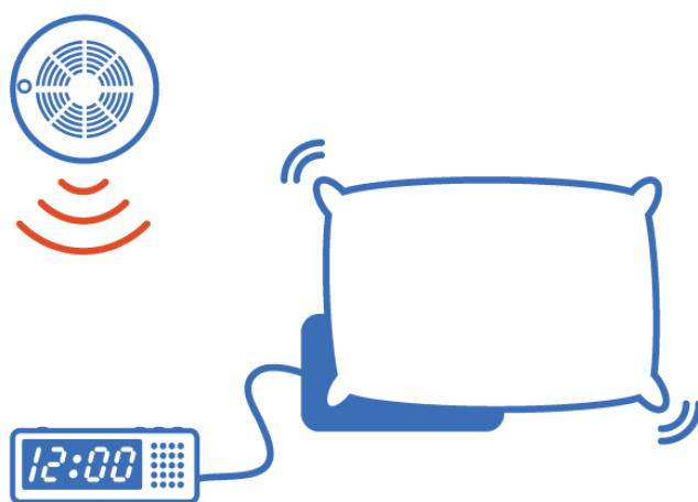
Illustrasjon 11: Vekkeklokke med audiodetektor og vibrasjonsvarsling.
