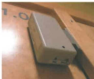
Sensor registrerer om døren åpnes
