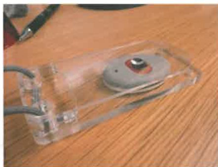
Spesialtilpasset trygghetsalarm med større trykkflate
