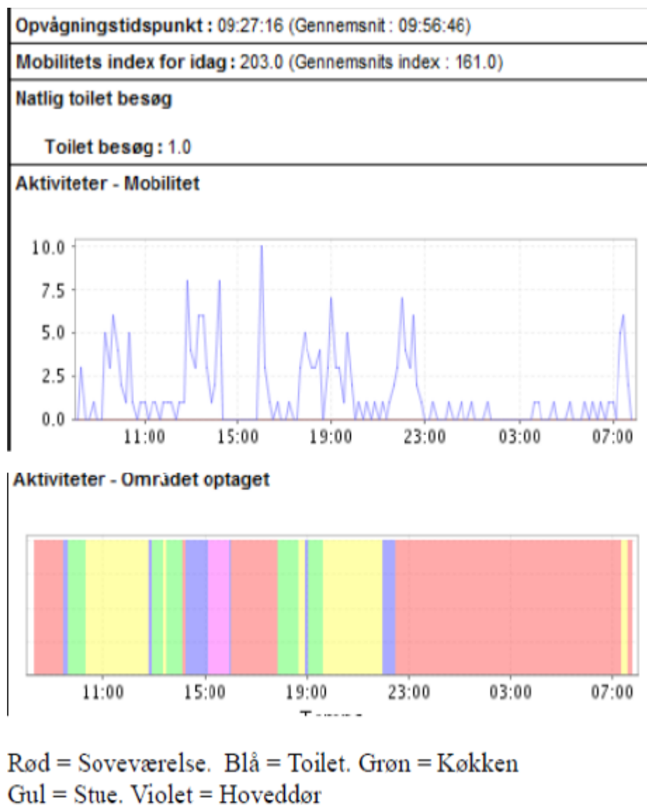
Figur 4: Web-siden til CuraTec som bl.a. viser brukers bevegelser gjennom døgnet basert på målinger fra bevegelsessensorer i leiligheten.
