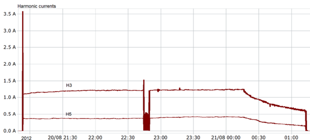
Figur 4-8 Overharmoniske strømmer som trekkes ved normal lading av elbil type 1 ved 14 A. Dette er den samme ladesyklus som i Figur 4-1.
