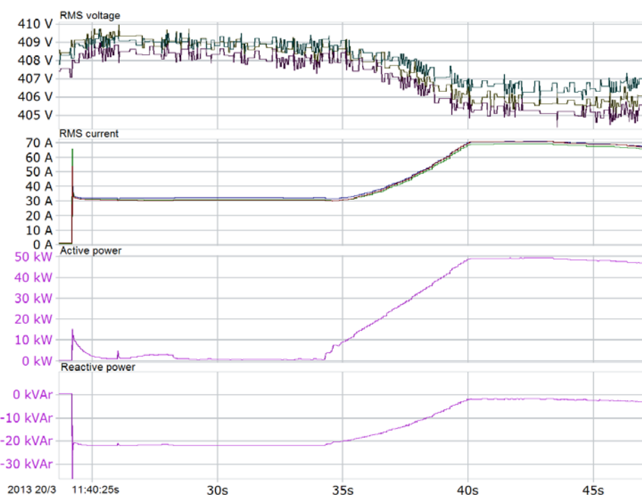
Figur 5-6 Oppstart av hurtiglading ved lokasjon C.
