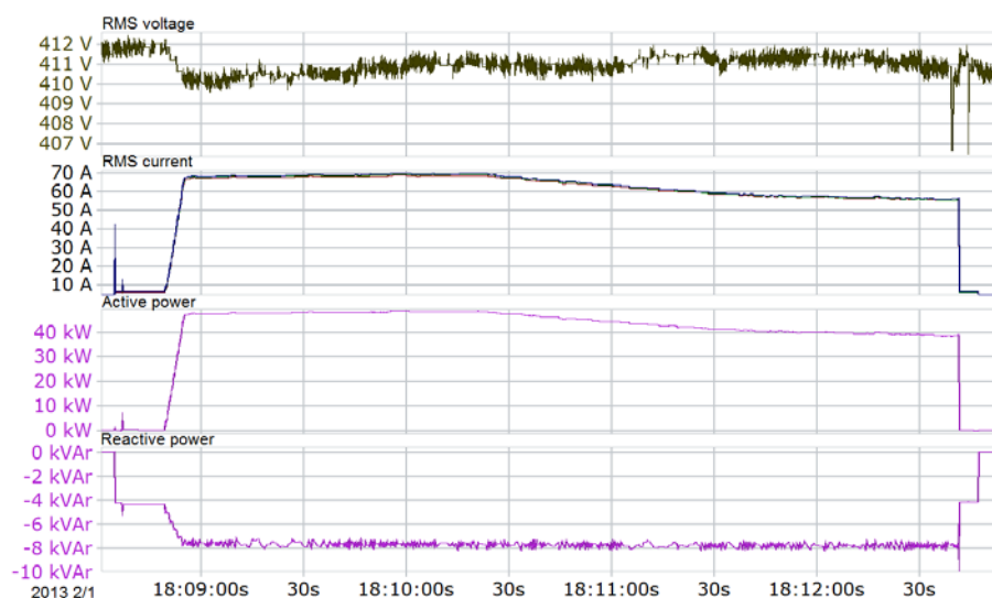
Figur 5-3 Kort ladeforløp (cirka 4 minutt) ved lokasjon A. Ved oppstart rampes effekten opp. Ved ladestopp faller effekten momentant, trolig avbrutt av bruker.
