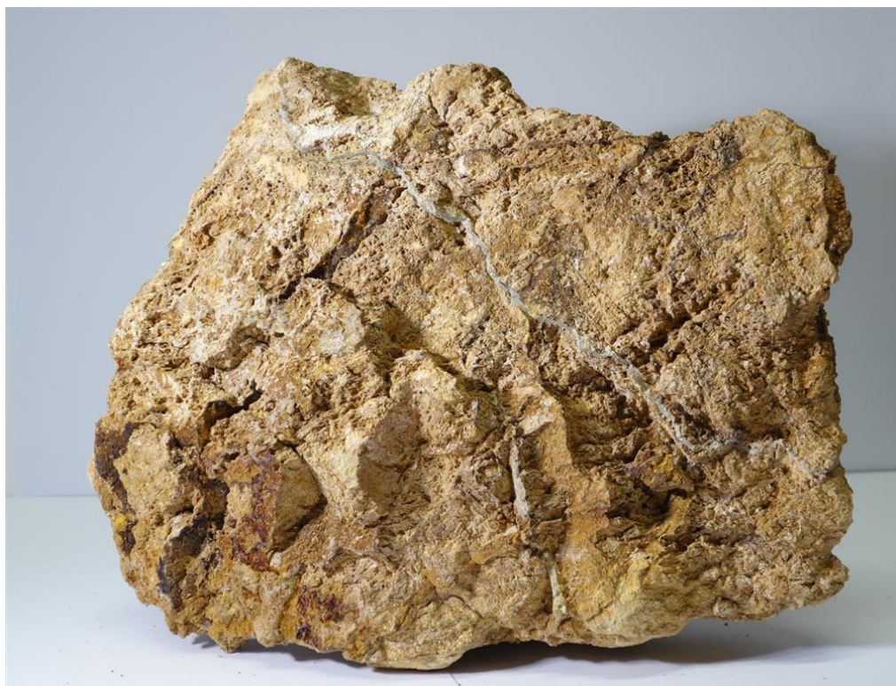
Fig.3 Mikroement fyller tynne sprekker i det lite konsoliderte sideberget
