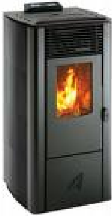
Fig 5.6 Enkel biopellets-kamin. Krever pipeløp, samt strømforsyning til tenning og drift av ventilasjonsvifte (ca 100 W)
