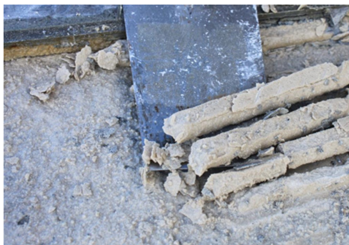
Figur 6: Frostskaadet lim kan smuldre opp og miste fasthet.
