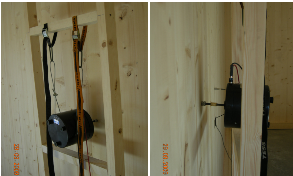
Figur B-2. Rystebord opphengt for eksitering av vibrasjoner i vegg
