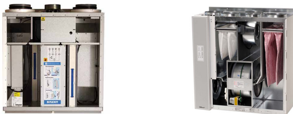
Figur 5.3 Eksempler på moderne ventilasjonsaggregater for småhus. Begge med roterende varmeveksler, energieffektive EC vifter, og bypass for tilkobling til komfyrvtrekk. Kilder: Flexit (venstre) og Systemair (høyre)
