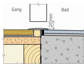
(a) Spalte under dørblad
