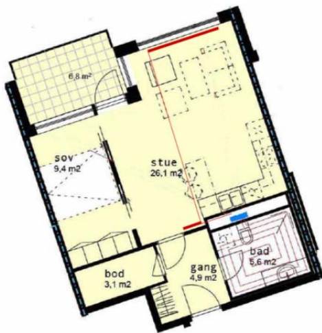
Figur 4.12 Plassering av varmekilder. Lavenergibolig LE1 Effektbehov beregnet til ca 1100 Watt
