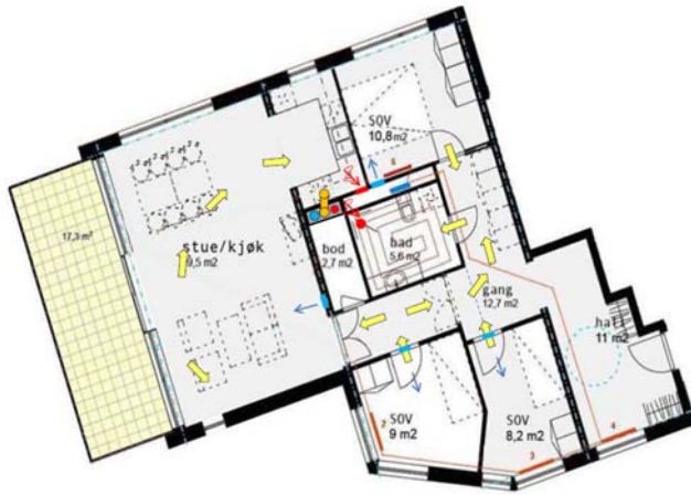
Figur 4.1 Ventilasjonsluftens gang ved balansert ventilasjon
