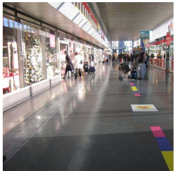
Fig. 41. Det er et parallelt ledelinjesystem, bestående av klebet plastfilm, som sannsynligvis er relatert til reklame.
