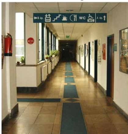
Fig. 18. Kontrastfarget ledelinje i gulv på universitetet i Budapest. Dørene og retningsforandringen er markert med piler.
