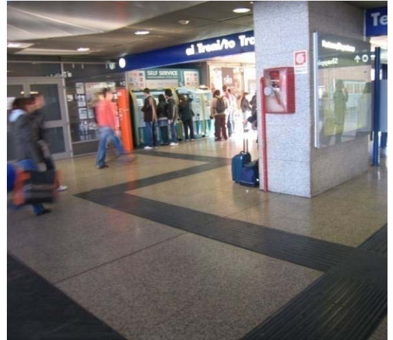
Fig. 38. Et eksempel på unødvendig komplisert ledelinje til automat. Plassering av automater bør vurderes i forbindelse med utførelse av ledelinjene.
