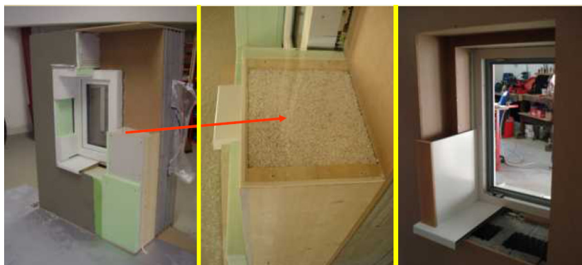
Figur 61 Forsøksvegg med innsatt vindu. Til høyre ser vi vinduet innenfra og ut gjennom eksisterende veggåpning (faktor 10).
