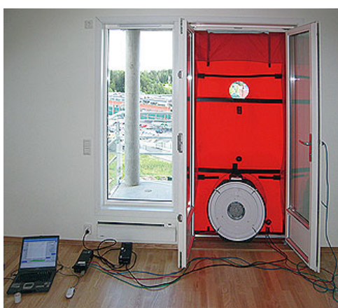
Figur 2 Måling av lufttetthet Byggforskeren 720.035 Måling av bygningers lufttetthet.
