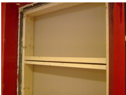
Foto 4.3.10. Prøvevegg for måling av spalteventiler (200 mm vegg).
