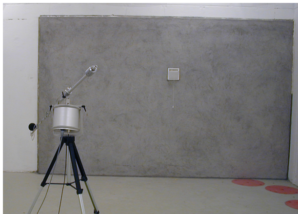
Foto 4.4.1 Klaffeventil montert i laboratoriet
