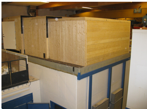
Foto A3. Senderrom/teleskophus (lukket stilling) og klangrom
