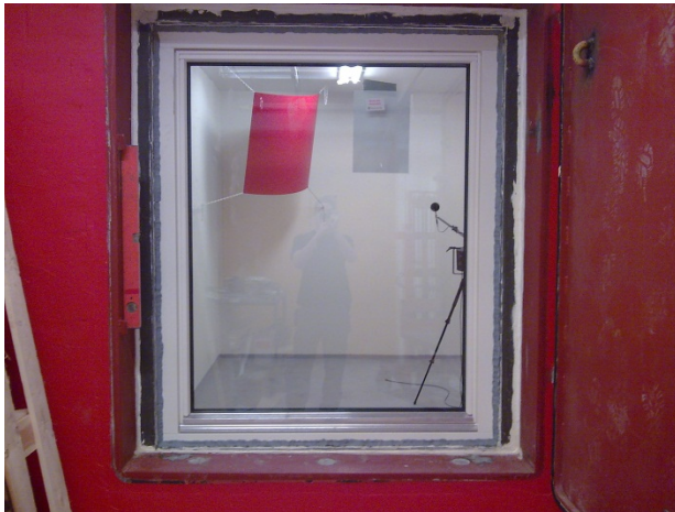
Foto 2.3.5. Vindu montert i prøveåpningen sett fra klangromssiden
