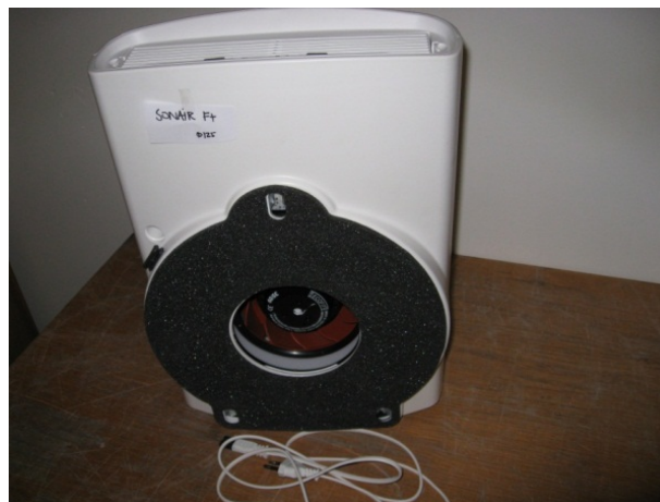
Foto 4.3.16. Mekanisk ytterveggventil (Fresh F+)
