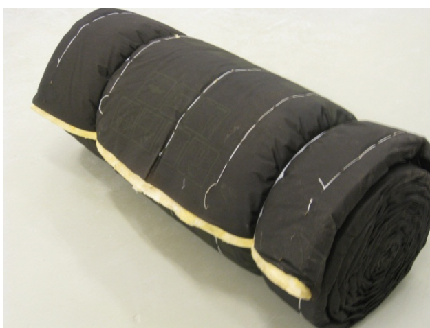
Foto av tak 4.3 og 4.4. Sydd matte (isolasjon)
