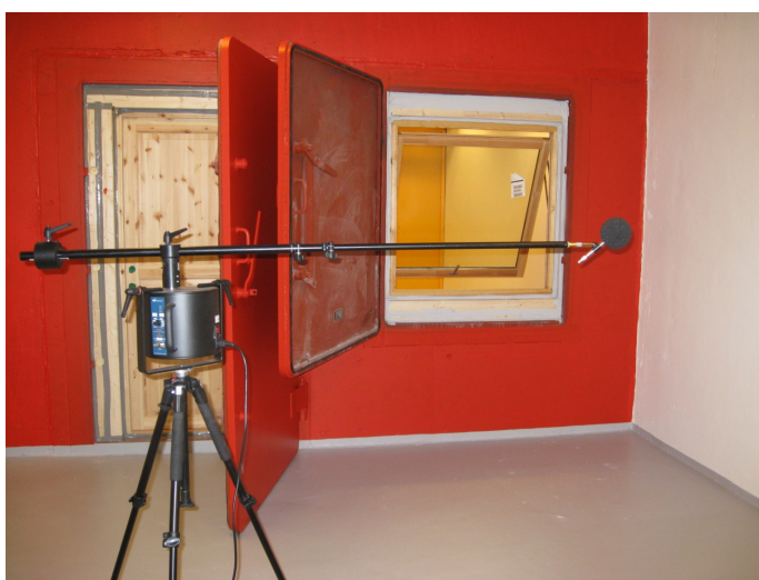
Foto 2.1.1. Lydlaboratoriet for dører og vinduer sett fra klangrommet
