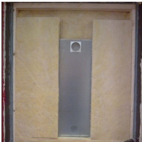
Foto 4.3.12. Innbygging av Fresh Z-dB i 200 mm vegg med mineralull, delvis isolert
