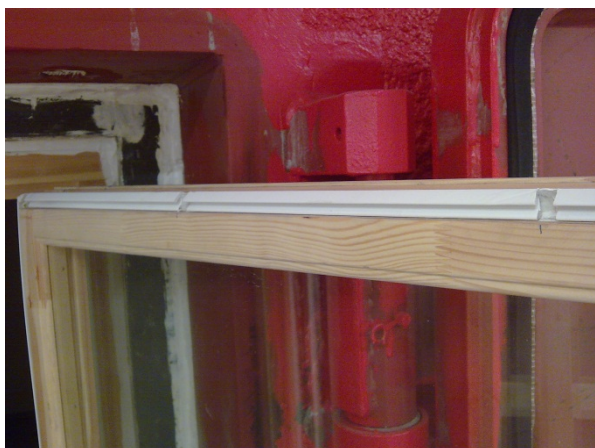
Foto 2.3.3. Spalter i pakning i øvre ramme
