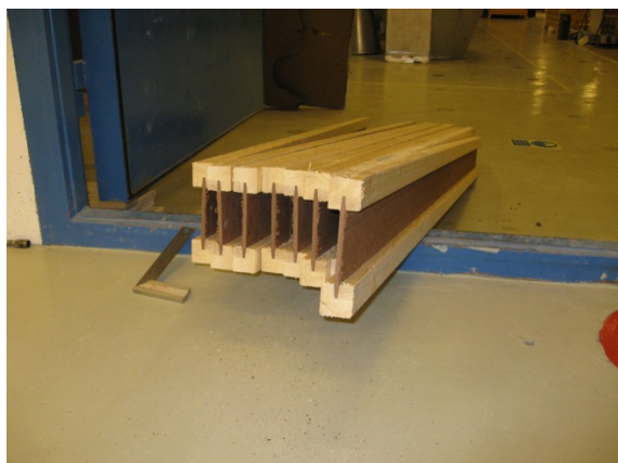
Foto av vegg 5.1. Stendere av 200 mm I-bjelker
