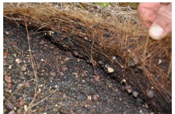
Sedum er etablert på kokosmatte med mineraljord. Foto: ILP/UMB
