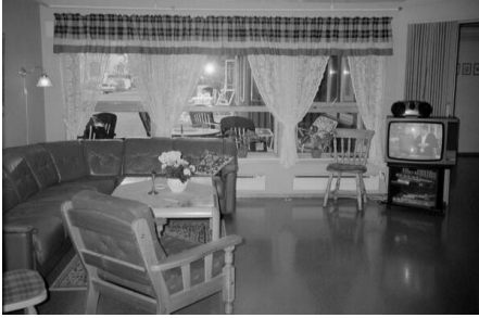
Lav brystningshøyde kommer i konflikt med høyrygget sofa og krever at den som møblerer tar hensyn til den. Er det tatt hensyn til plassering av TV i planleggingen? Foto Rove 3-tallet
