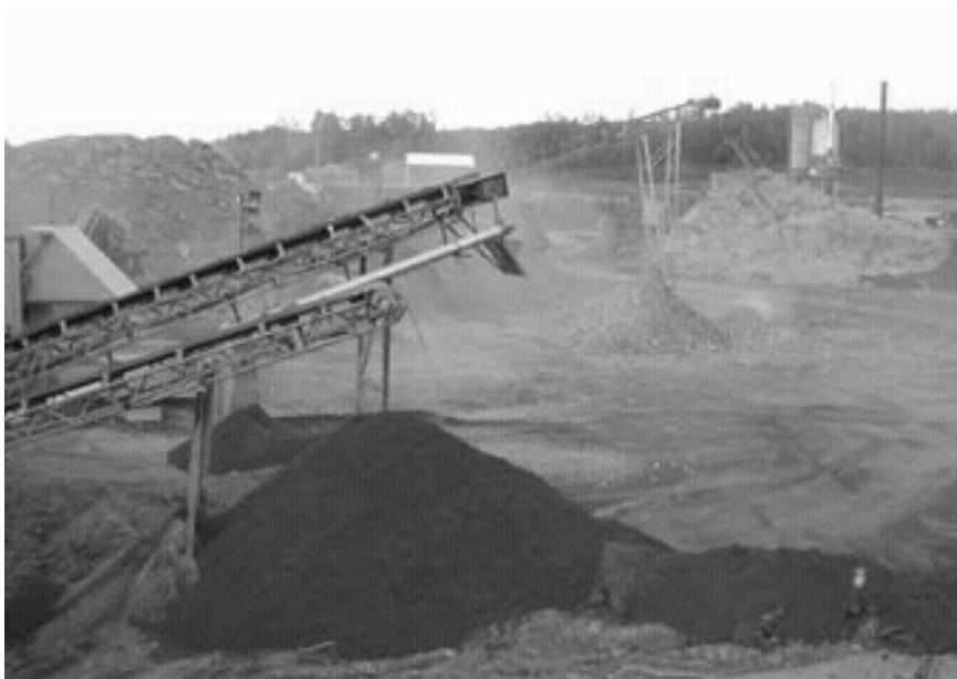
Figur 2. Produksjon av resirkulert tilslag hos BA-Gjenvinning i Oslo
