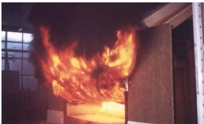
Figur 5.3.3 Fra brannforsøk. Bildet viser flammepåkjenningen ved takfot
