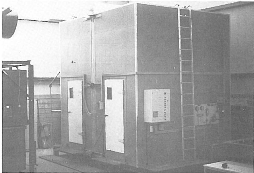
Fig. 8 Varmestrømsapparat (hot-box) for måling av konstruksjoner
