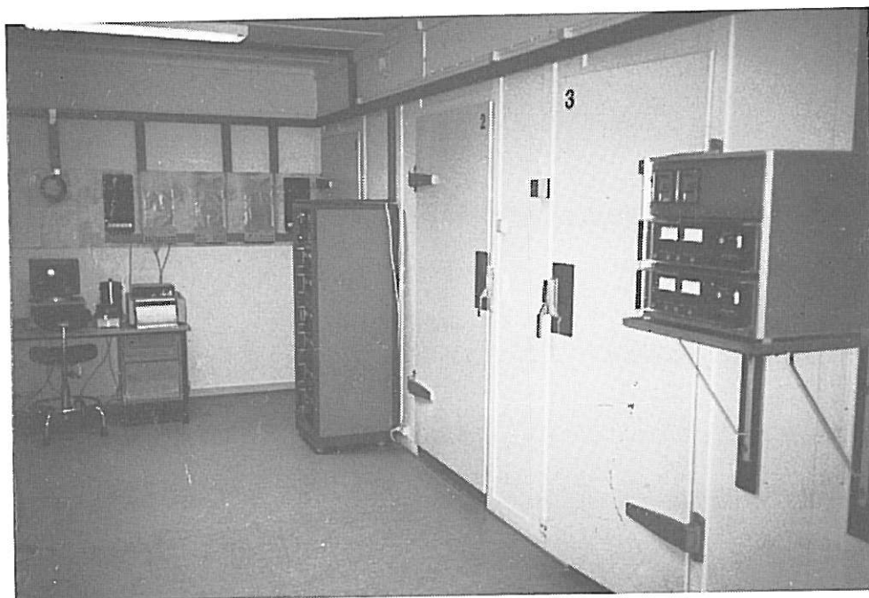
Fig. 7 Utsnitt av prøverom. Fire plateapparater er plassert i hvert sitt temperaturutstyrte kammer.
