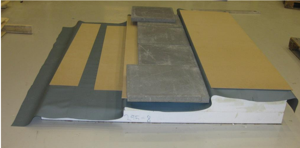
Figur 4. Liming av takfolie til EPS.
