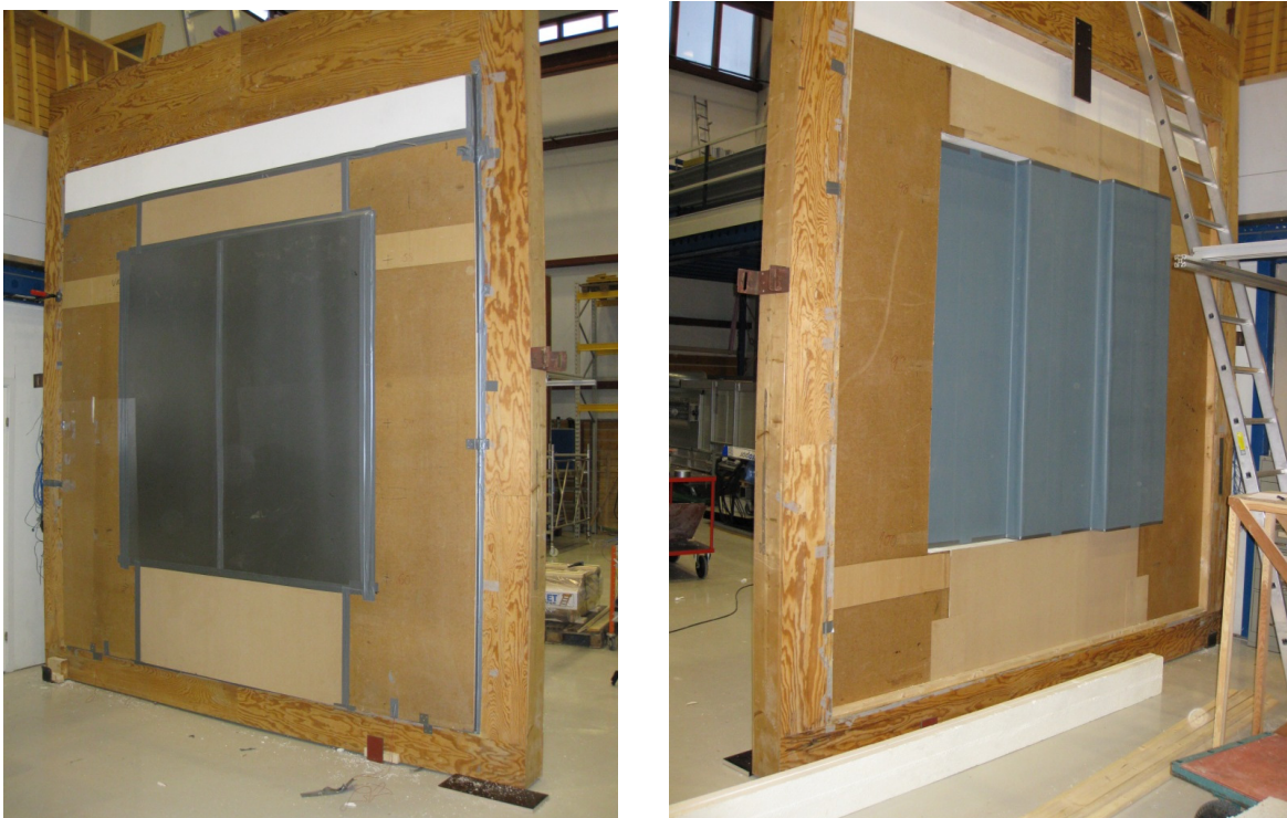
Figur 5. Prøvefelt, varm side til venstre, kald side til høyre.
