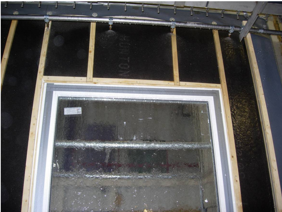
Figur 2.1 Prøvofeltet i slagregnskapet under prøving
