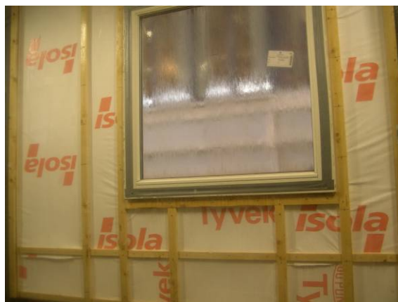
Figur 3.11.2. Prøvefeltet under slagregnsprøvingen
