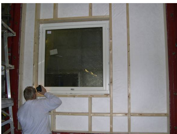
Figur 3.11.3. Observering av vannlekkasjer ved prøving i slagregnskap
