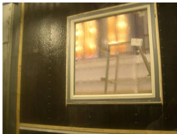
Figur 3.5.2. Prøvefelt under slagregnsprøvingen. Ingen vertikale lekter
