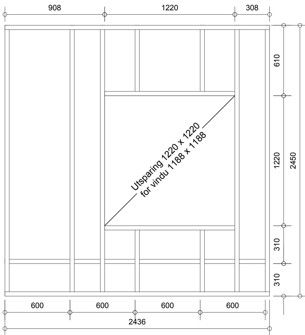
Figur 3.1 Detaljerte mål (mm) for bindingsverket i prøvefeltet
