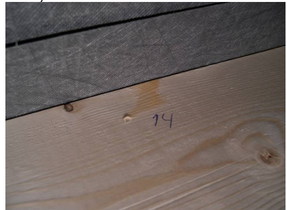
Figur 31 Lekkasje nr. 14 under kjøring med nedsilende vann og pulserende lufttrykk
