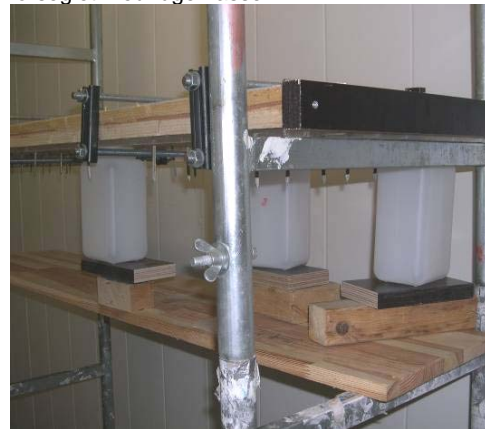
Figur 9 Oppsamling av vann i bokser under prøvene
