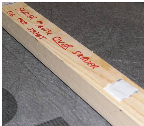
Figur 24 Sløyfe med butyl lapper over skruerhoder
