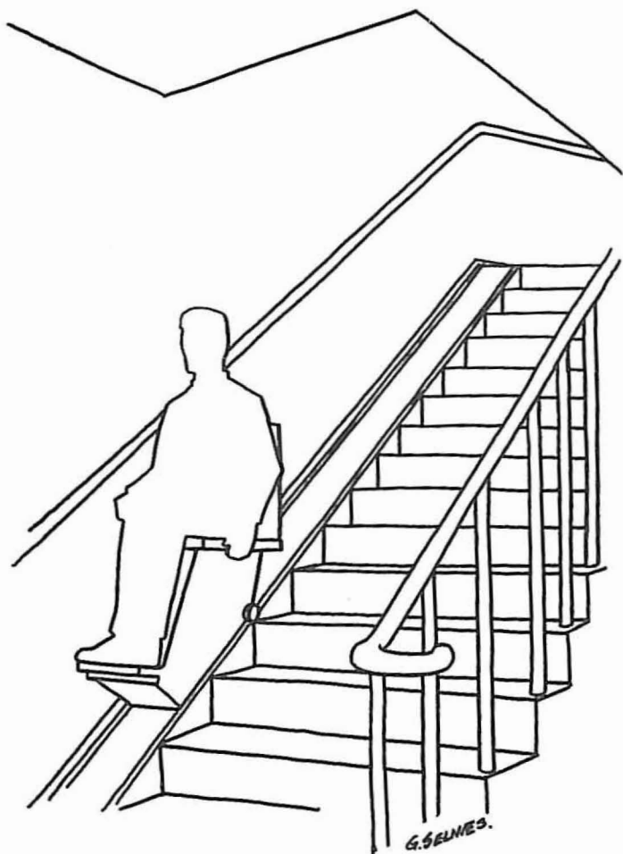
Fig. 4: Skjematisk fremstilling av en trappeheis.
