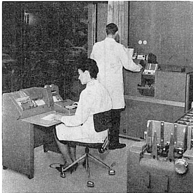
Bilde 3. Til venstre punchemaskin, til høyre sorteringsmaskin og i bakgrunnen tabulator IBM-444.
