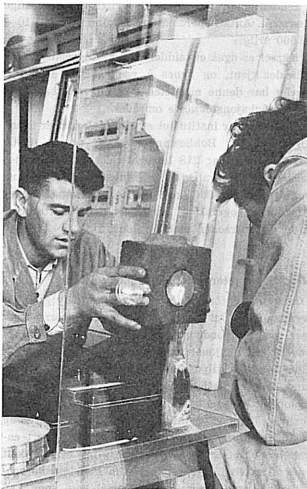
Fig. 5. Undersøkelse av duggpunkt for isolerglass.
