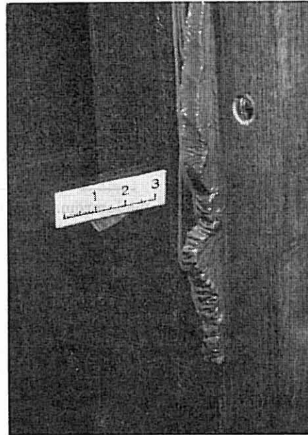
Fig. 17. Lysebrun Peremator, metode V. Utpressing og siging. 22. periode sterk kuling ved en utelufttemperatur på + 10 °C.
