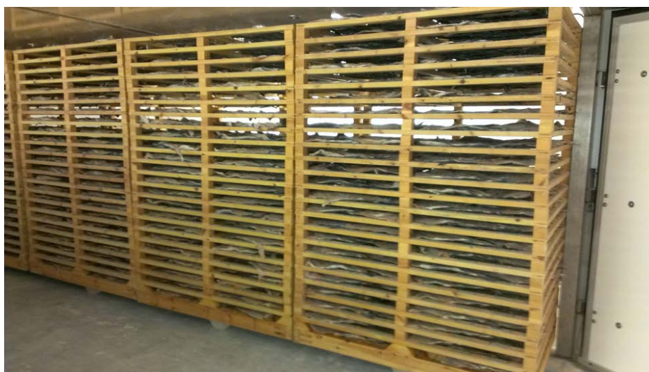
Figur 8: God nok plass mellom brettene, lite rom for falskluft rundt vognene.
