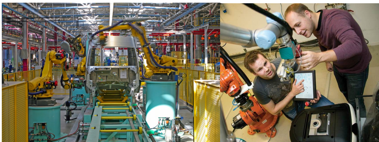
Figur 6 Tradisjonelle industriroboter er buret inn for sikkerhet, mens de nye industrirobotene tillater samarbeid med mennesker (Foto: Shutterstock & SINTEF)
