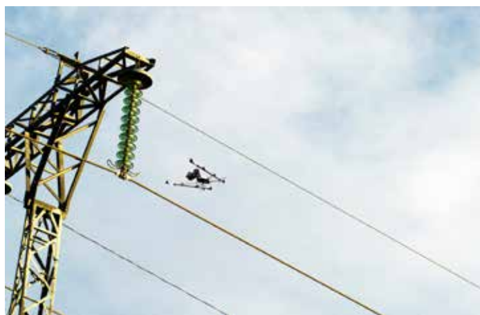
PRAKTISK: Orbitons drone kan utføre en rekke jobber langt enklere, raskere, billigere og mindre risikofyllt enn mennesker. Som her, hvor den inspiserer en høyspentmast.
