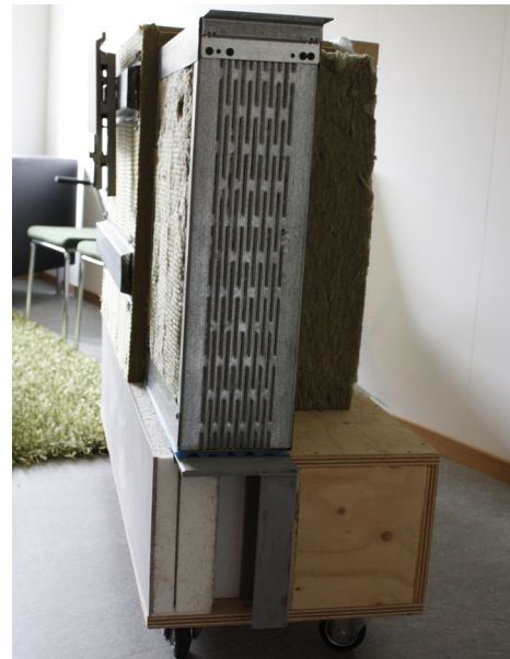
Veggkonstruksjonsmodell (Kilde: SINTEF Byggforsk)
