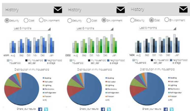
Figur 3 a, b, c: Eksempel på test av app-løsning for kommunikasjon/informasjon og kontroll i husholdningers energibruk, visualisering av AMS teknologi i Demo Steinkjer (a) Sikkerhet; (b) Miljø; (c) Kostnader. App-løsning: K Tønnesen, basert på forskning av og i samarbeid med Erica Löfström. (OBS: I denne visualiseringen foreslås at også andre måledata enn husholdningselektrisitet er inkludert.)
