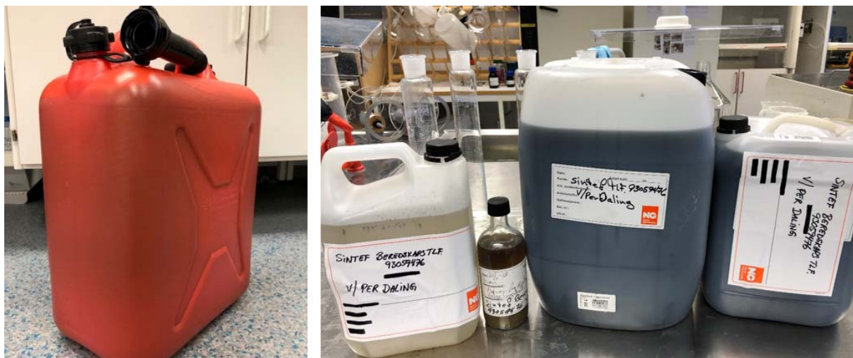
Figur 2.1 Mottatte prøve: Rød kanne fra nødlossingen (20 L, 2018-10211), prøver som ble tatt opp på sjøen er vist i høyre bilde: Vannprøve (5L, 2018-10291), vann-oljeprøve (1 L, 2018-10292), olje (20 L, 2018-10293) og olje (5 L, 2018-10294).
