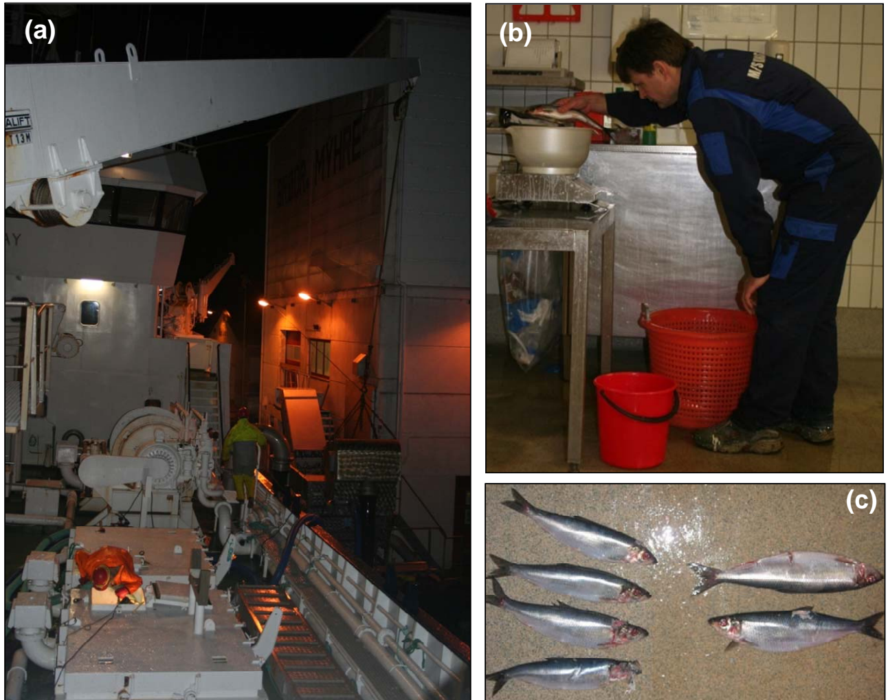
Figur 4: a) Landing av fangst, kort vei fra fartøy til landanlegg. b) Veiing av mengder skadet fisk. c) typiske skader blant fiskepumpet fisk.
