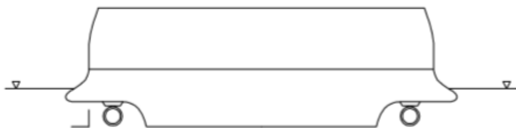
Figur 11: Pendelferge skisse i snitt midt i fartøyet (Kilde: SINTEF Ålesund).
