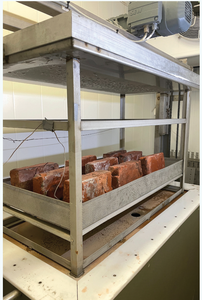
SINTEF har utviklet vurderingsmetoden for frostmotstand metode NBI 134. 10 av 10 stein skal tåle 84 frysetinesykluser uten betydelig skader eller vekttap. Da er de bevist egnet til bruk i fasader i værhardt norsk klima. Foto: Håvard Hyndøy
