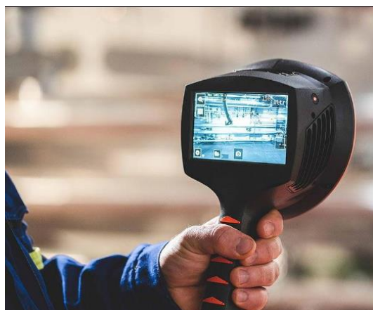
Figur 19 Eksempel på akustisk kamera (FLIR.com)
