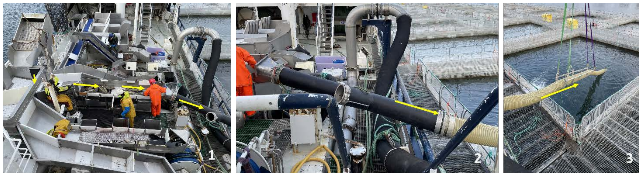
Figur 7. Levende fisk pumpes opp fra tanker og sorteres (bilde 1). Levende fisk telles og sendes videre ut i levendelagingsmerd (bilde 2 og 3). Død og slapp fisk bløgges og sendes til lagring på RSW tank (-1,5°C) frem til levering ved prosesseringsanlegg.
