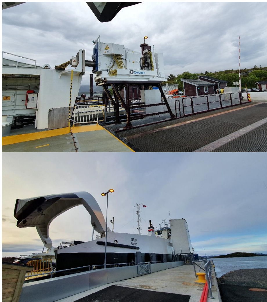
Figur 13 - Øverst: Frontplugg med landkontakt på kjørebri i Sandvika. Nederst: Sideplugg med ladetårn på kai på Tømmervåg.
