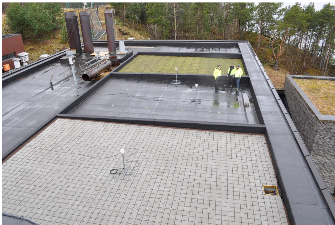
Figur 2 Høvringen testfelt med tre uavhengige tak, felt 1 nærmest kamera (Foto: Tore Kvande, NTNU).
