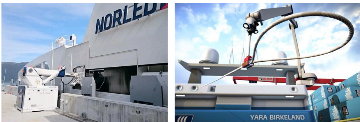
Figur 7: (Venstre) Cavotec sitt MoorMaster system til vakuumfortøyning og lading. Foto: Cavotec. (Høyre) MacGregor sitt auto-mooring system vurdert brukt for Yara Birkeland. Foto: MacGregor.
