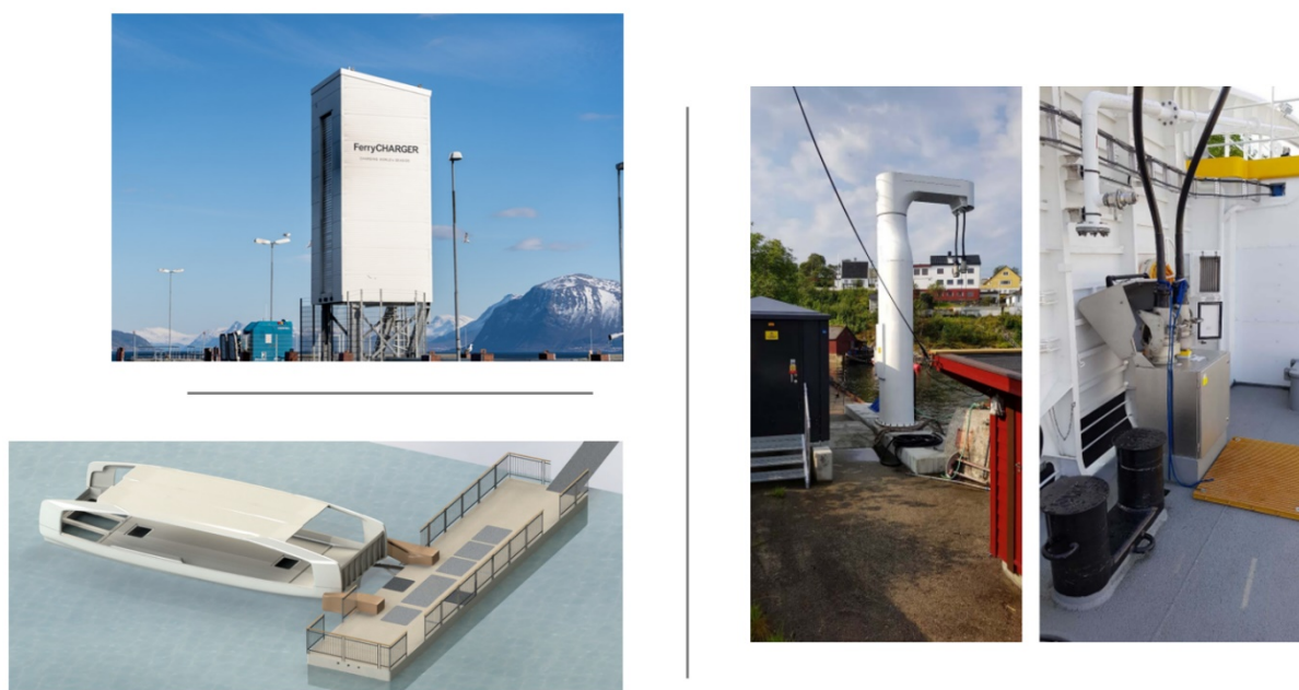
Figur 12: (Venstre opppe) Eksempel på høyspent ladetårn for større ferger, fra Stemman-Technik [28], Foto: Stemman-Technik. (Venstre nede) Konseptuell ladebrygge for autonom passasjerbåt fra Hyke, med induktiv (trådløs) lading [29]. Foto: Hyke (Høyre) Semi-manuell ladeløsning for mindre ferger [30], Foto: Brekke Strand
