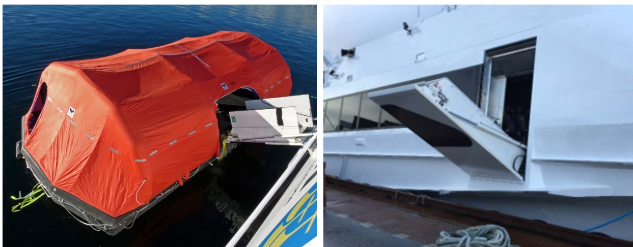
Figur 10: Viking Undertun-system. Eksempel på løsning med oppblåsbar redningsflåte som er integrert i skutesiden. Systemet utløses ved hjelp av en knapp (fra bro eller på oppbevaringsboks). For mer detaljert informasjon om systemet henvises leseren til systemets produktside og datablad [22]. Foto: Viking
