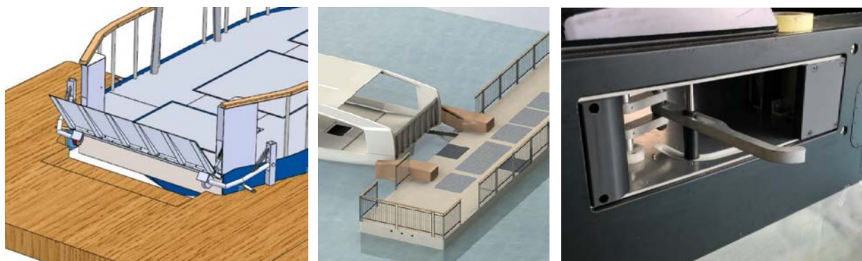
Figur 8: (Venstre) Et mulig fortøyningsystem som ble undersøkt under Autoferry -prosjektet for bruk på milliAmpere [15]. Foto: NTNU. (Midt) Fortøyningskonseptet for byferger fra Hyke [16]. Foto: Hyke. (Høyre) Roboats i Amsterdam skal kunne dokke automatisk ved hjelp av en mekanisk låsemekanisme [17]. Foto: MIT.
