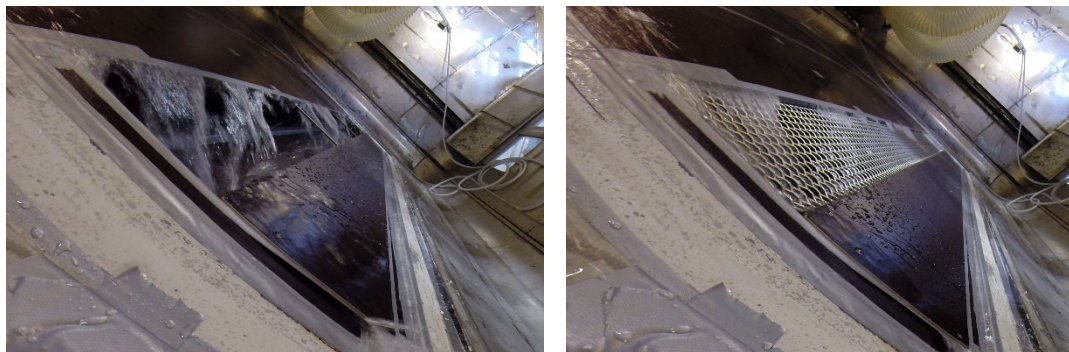
Figur 3.2: Testing av takrenneløysningar i laboratoriet. Kraftige regnskyll på glatt taktekning gir mykje vatn som renn i stor fart nedover taket. Med for smal takrenneåpning vil ikkje vatnet bli fanga av takrenna (venstre foto). Bruk av rist kan leide vatnet ned i renna og samtidig hindre at løv blokkerer taknedløpa (høgre foto).
