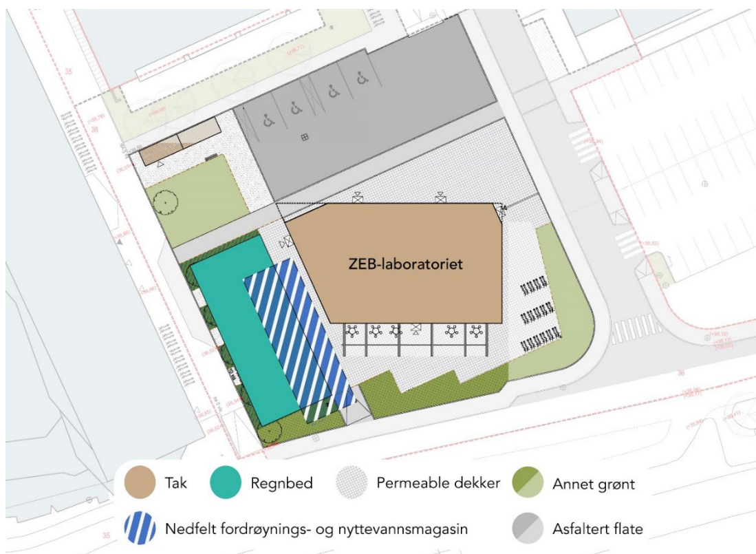
Figur 3.14: Overvannssystemet rundt ZEB-laboratoriet.
