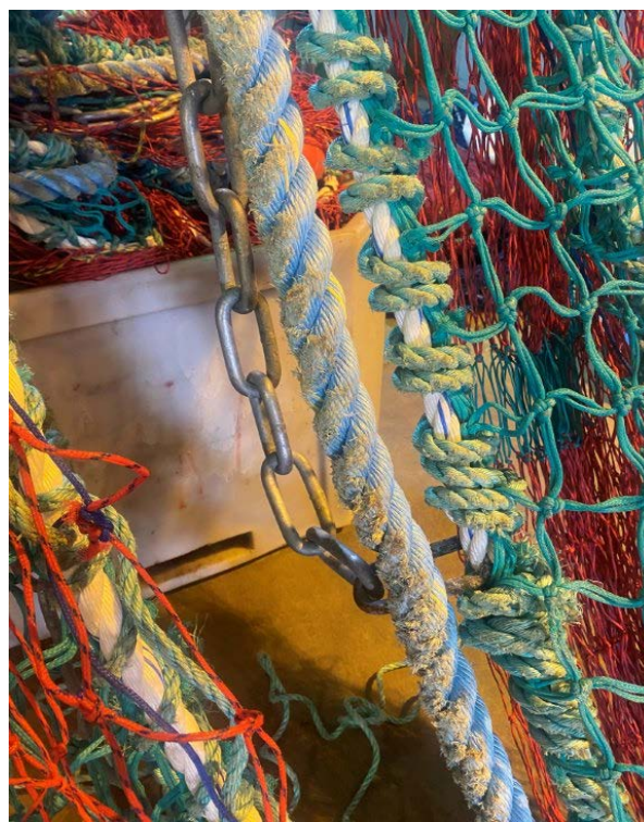
Figur 7-4 Eksempel på slitt skjørt (sabb) på nota. Foto: Jørgen Vollstad
