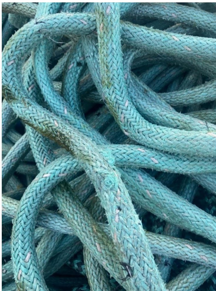
Figur 4-4 En slitt flytetelne som er ca. 20 år gammel Foto: Jørgen Vollstad
