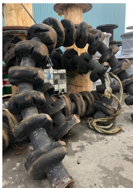
Figur 8-3 Trålgear med synlige slitasjetegn på skivene. Foto: Grethe Lilleng
