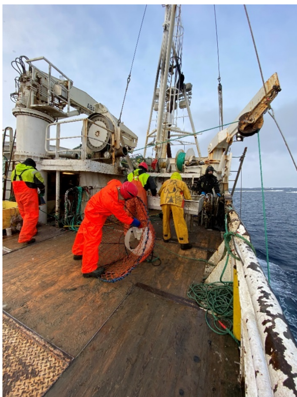
Figur 6-4 Haleutstyret på en snøkrabbebåt. Til høyre for kranfoten ser vi kveileren (også kalt haleren) som drar opp tauet. Foto: Jørgen Vollstad
