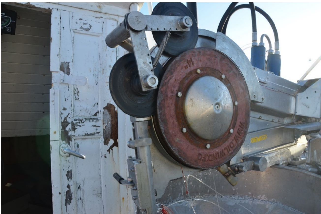
Figur 5-7 Linekveiler med presshjul og kniv. (Foto: Jørgen Vollstad)
