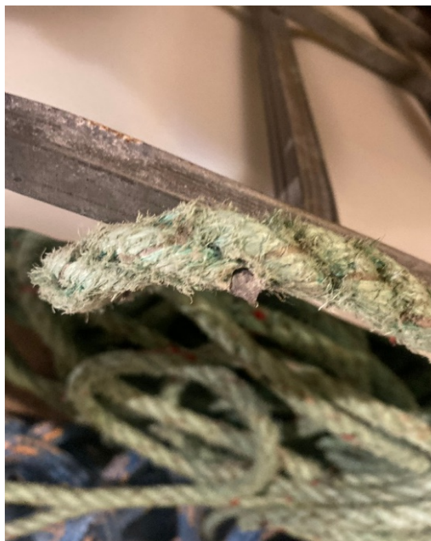
Figur 4-3 En utslitt blytelne hvor blyfragmenter har begynt å stikke ut. Foto: Jørgen Vollstad
