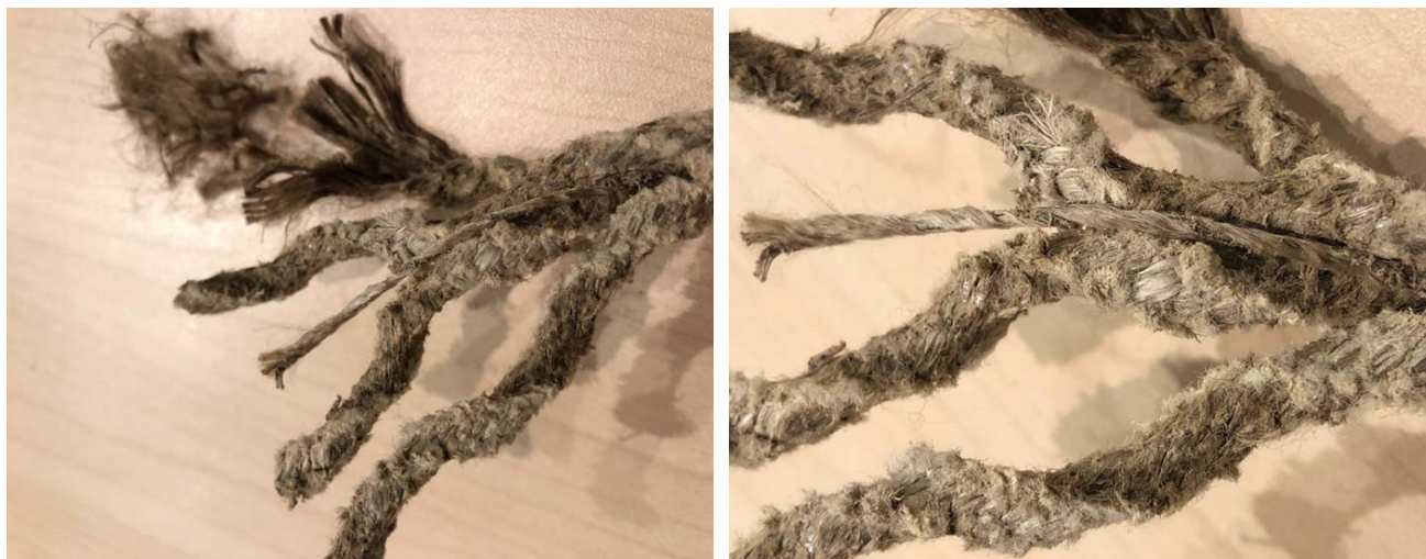
Figur 5-10 Nærbilder av slitt linerygg. En ser tydelig slitasjen når kordelene er tatt fra hverandre. Foto: Grethe Lilleng
