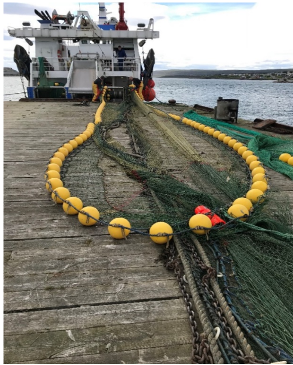
Figur 8-7 Sabb til venstre har samme misjon som et rockhopper gear. Til høyre ser vi trålen dratt ut på kaia. Dette er en Lenangstrål 1750# som brukes av mange kystrekfiskere i Nord-Norge. Foto Jørgen Vollstad.
