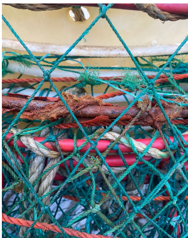
Figur 6-6 To eksempler på slitasje og avskalling av plastbelegg på snøkrabbeteiner. Til venstre en koreateine kjøpt i 2013, til høyre en nyere teine med sterkere plastcoating. Foto: Jørgen Vollstad
