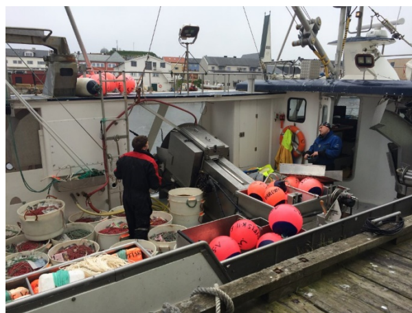
Figur 5-6 Blåsene settes i stampeskillet, disse er nummerert. Midt på bildet sees sløyemaskinen. Foto: Jørgen Vollstad
