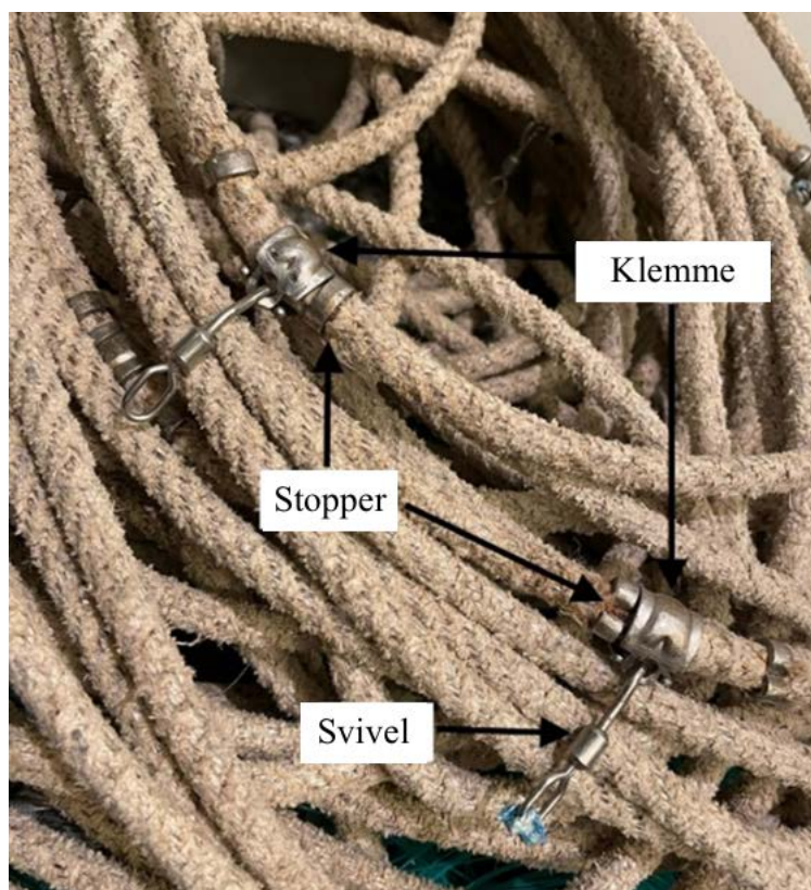
Figur 5-8 De ulike komponentene på en autoline som består av stål. Foto: Grethe Lilleng.
