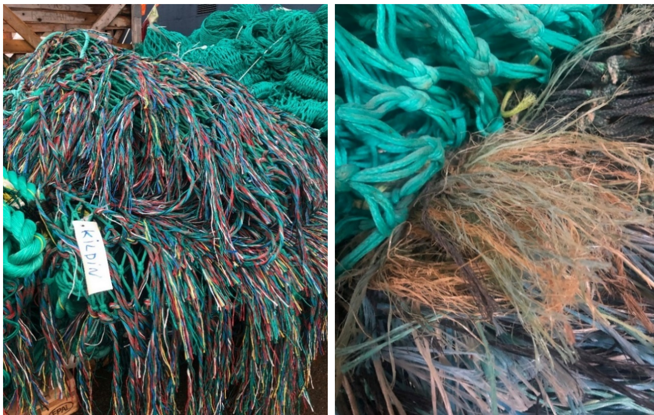
Figur 8-6 Bilde av en ny (venstre) og en slitt (høyre) labbetuss. Foto: Grethe Lilleng
