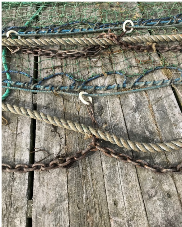
Figur 8-7 Sabb til venstre har samme misjon som et rockhopper gear. Til høyre ser vi trålen dratt ut på kaia. Dette er en Lenangstrål 1750# som brukes av mange kystrekfiskere i Nord-Norge. Foto Jørgen Vollstad.
