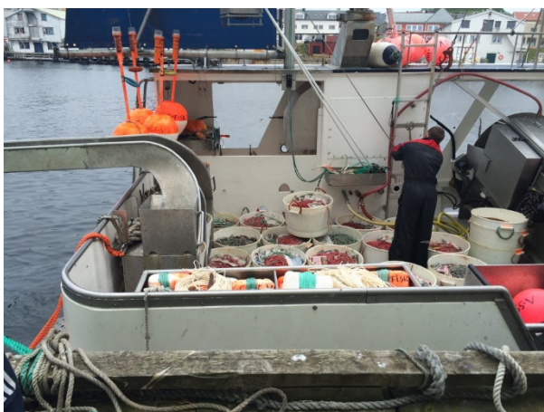
Figur 5-5 Flytelinebåt i Vardø, lina tas om bord. Nærmest på bildet ser vi fløytene (isoporbiter med tynt tau surret rundt) og ferdig egnede linestamper. De orange bøyene oppe til venstre er AIS bøyer, ved å bruke disse har en lettere kontroll på hvor flytelina befinner seg. Foto: Jørgen Vollstad
