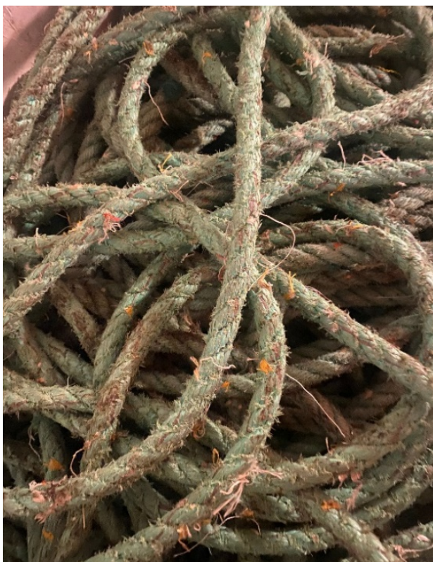
Figur 4-2 En utslitt blytelne. Foto: Jørgen Vollstad
