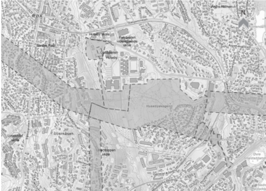
Figur 1 Oversiktskart som viser plassering av vannbehandlingsanlegget som bygges på Huseby. Fjellhallene bygges i tre nivåer under Husebyskogen. Det er bygget adkomsttunnel fra Husebyjordet ved Huseby skole og fra Skiparken ved Makrellbekken.
