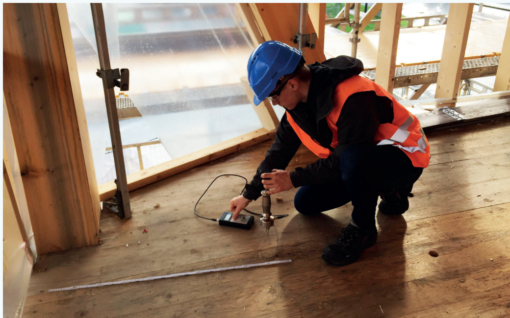
Fuktmåling i massivtredekke i ZEB-laboratoriet.
