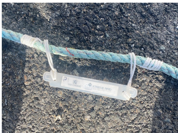
Figur 3-2 Eksempel på innfesting av merke med nylontråd, type XTR Uno.
