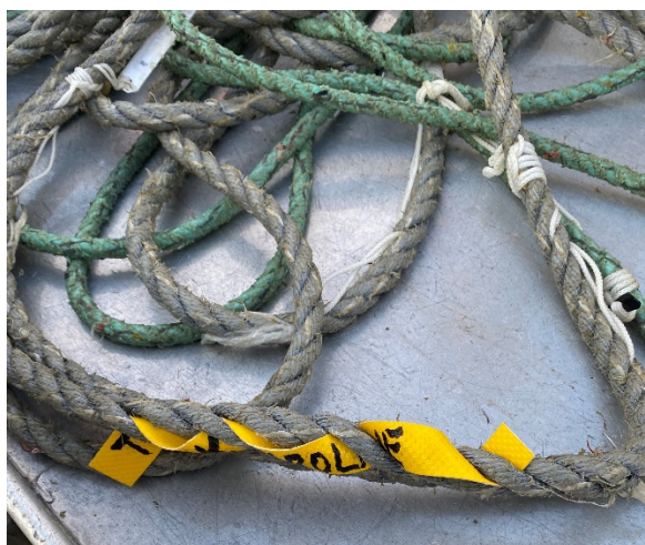
Figur 3-14 Feste av egenprodusert merke som er tredd gjennom kordelene.
