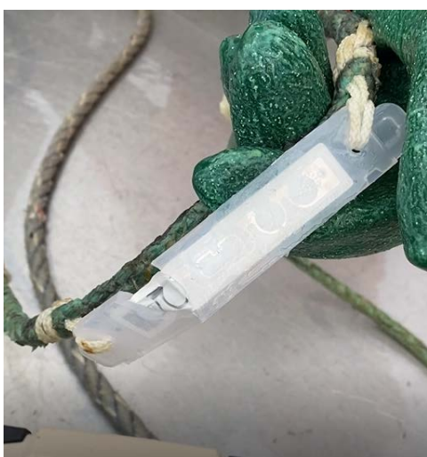
Figur 3-18 Knekt RFID merke, XTR Uno
