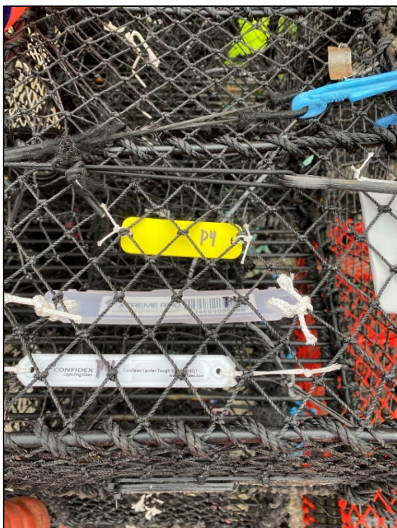
Figur 3-26 Tre av RFID merkene montert i taket på teina, plassering P4.
