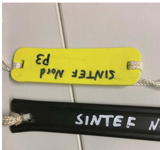
Figur 3-4 Skadet festehull på RFID merker, XTR Cart.
