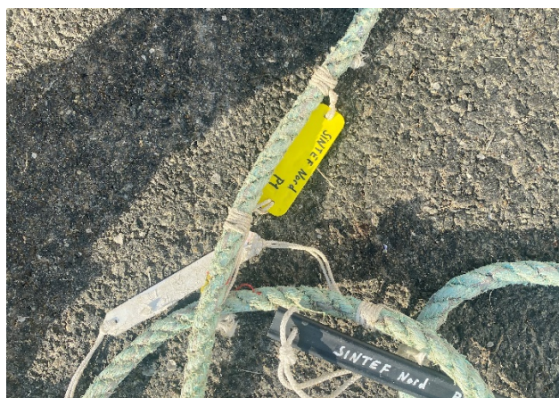
Figur 3-3 Eksempel med flere merker festet til flytetelna
