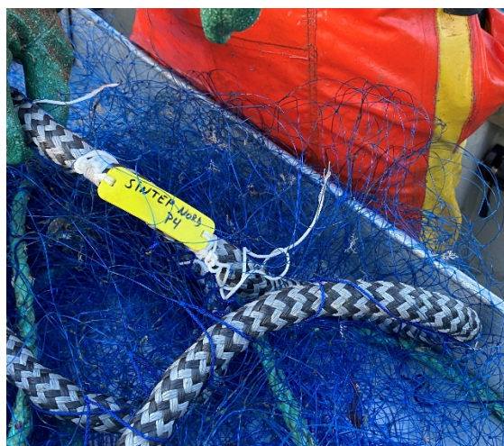
Figur 3-15 RFID merke festet stramt til blytelna.
