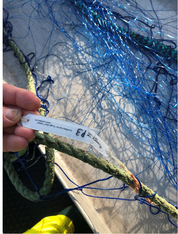
Figur 3-7 Knekt merke i blåkveitetesten, type Confidex Carrier Tough slim festet på blytelna.
