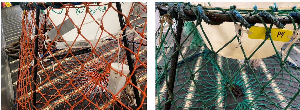
Figur 3-22 Eksempel på innfesting av merker på snøkrabbeteine
