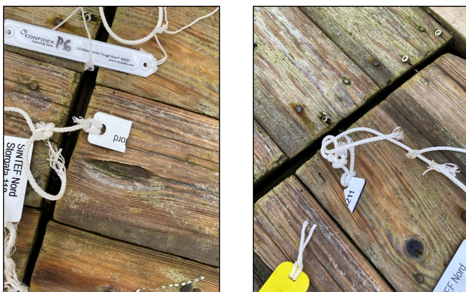
Figur 3-27 Knekte skiltmerker fra garnlenken
