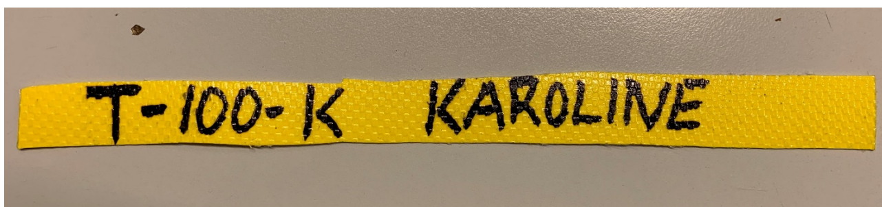
Figur 2-1 Merke laget av oljevernduk med tusj-påskrift
