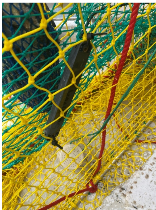
Figur 3-10 Survivor festet med strips til taket (gult lin)
