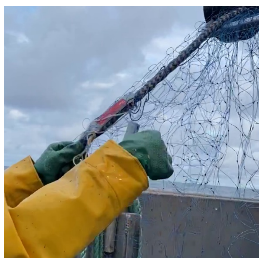
Figur 3-19 Merke som har heftet seg fast i garnmaskene, type XTR Uno
