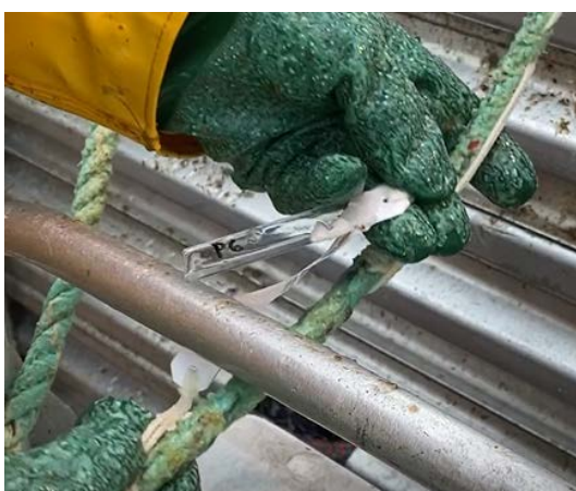
Figur 3-16 Knekt RFID merke, Confidex Carrier Tough slim
