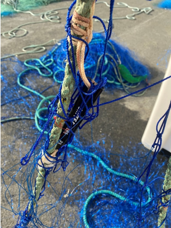
Figur 3-6 Merke som har forårsaket garnflope, type XTR Cart festet på blytelna.
