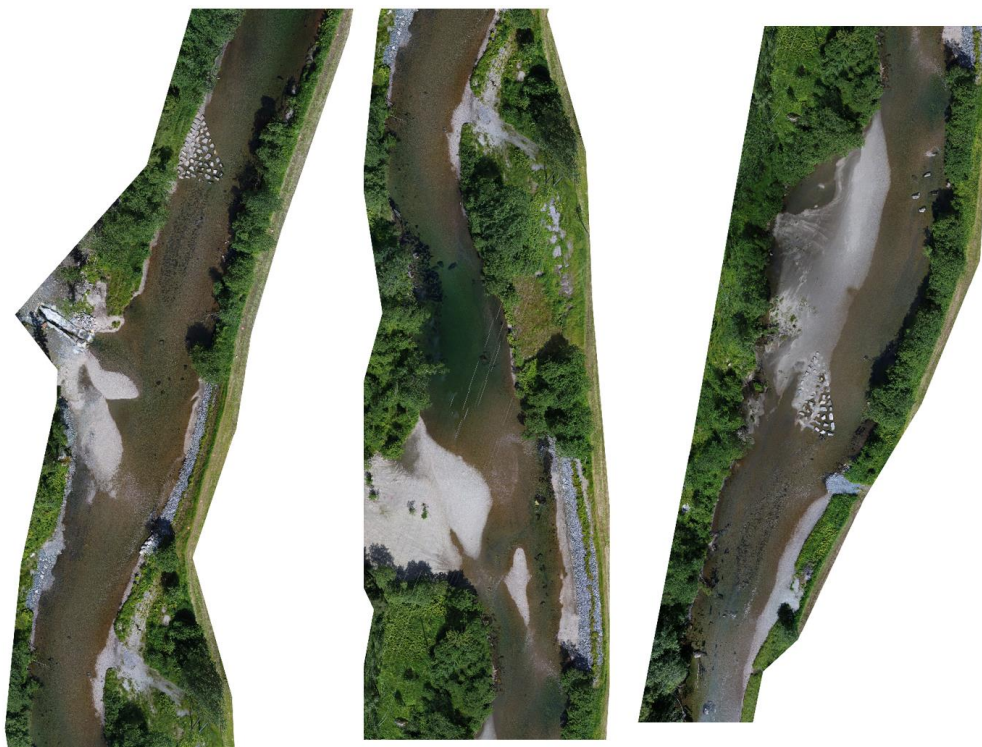
Figur 26. Detaljer av strekningen ved Langeland, med gjennomførte habitattiltak (utlegging av blokker) og erosjonssikring langs kanten. Ortofoto fra drone, 07/2017.
