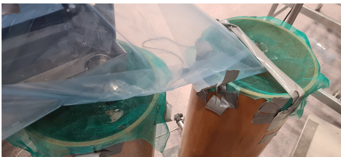
Figur 2. Renner og trykksylindere brukt til å måle avrenning. Avrenning over isolasjonssjiktet rant i en renne av plast over i sylindringen til høyre. Avrenning gjennom isolasjonssjiktet havnet i stålrenna (delvis synlig gjennom plasten) og sylindringen til venstre.
