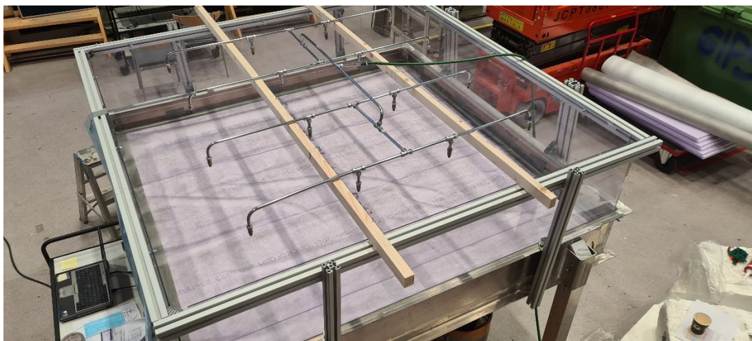
Figur 3. Testriggen for andre runde med forsøk, vinteren 2021/2022. På bildet er membran, isolasjon og geotekstil montert, men ikke ballasten.
