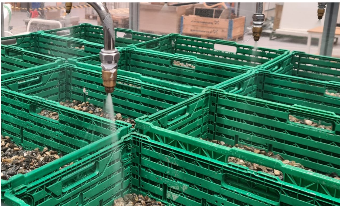
Figur 5. Dyser som påfører vann på testtriggen.
