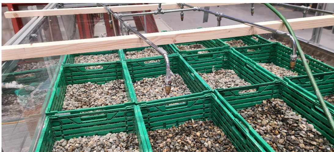
Figur 4. Ballast plassert i permeable plastkasser for enklere ombygging.
