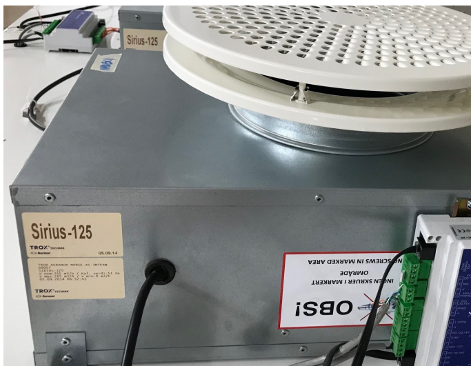
Merking av plenumsammer med ventil. Foto: SINTEF Community
