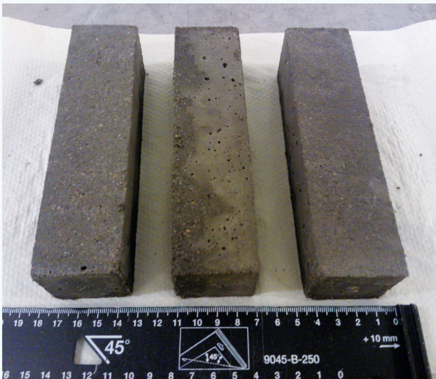
SINTEF og Oslo kommune har undersøkt om aske fra forbrenningsanlegg kan erstatte sement i betong.
