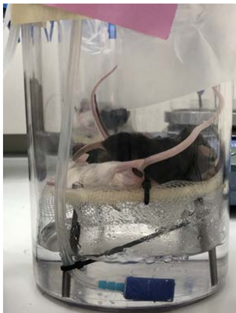
Figur 8. Lagringsforsøk med oksygen (lufting) men uten jord eller vann. Musekadavrene (3 hvite og en sort) ligger fritt på platået. I bunnen av karet er litt vann og lufta bobles gjennom vannet for å få så høy fuktighet som mulig. Fotografiet er tatt dagen etter oppstart.
