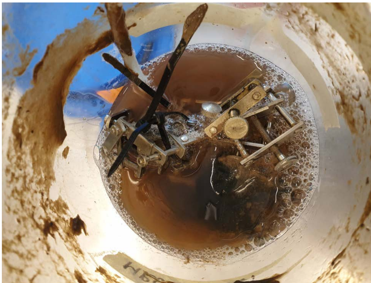
Figur B4-4 Karet med luftet jordvann sett ovenfra etter 87 døgn. Slangeklemmene ble benyttet som "lodd" for å holde musekroppene nedsenket i vannet.
