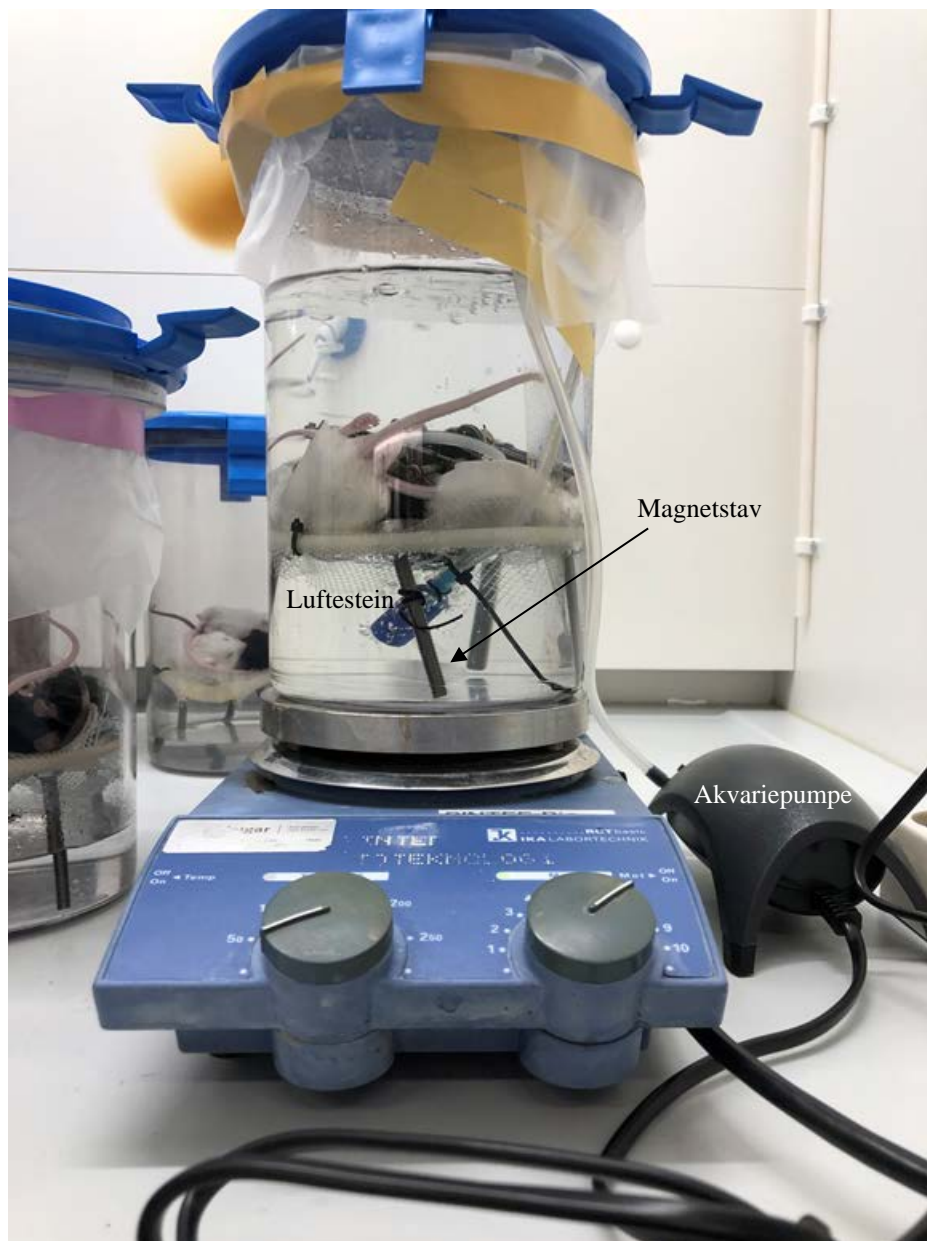
Figur 10. Lagringsforsøk med tilførsel av oksygen (luft) og musekadaverne nedsenket i vann, men ingen jord. Musene (2 hvite og 3 sorte) holdes nedsenket i vannet av en bunt med slangeklemmer. Lufting skjer vha. en akvariepumpe og via en sentralt plassert luftestein. Karet er plassert på en magnerører og magnetstaven som holder væsken i bevegelse kan så vidt skimtes. Karet er dekket med parafilm, mens lokket ligger løst oppå. Fotografiet er tatt dagen etter oppstart.
