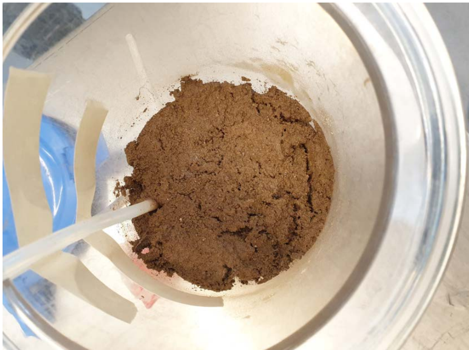
Figur B3-5 Kammer med jord med nedgravde mus. Slangen til venstre fører innpumpet luft inn under jordlaget for å sikre så god tilgang på oksygen som mulig.
